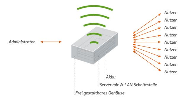
Server und Akku mit hoher Kapazität belegen zusammen in etwa eine Größe von  $12 \text{ cm} \times 8 \text{ cm} \times 4 \text{ cm}$ .
